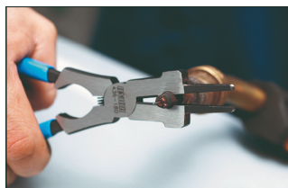
Αφαίρεση και τοποθέτηση μπεκ
